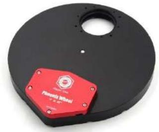
ホイール部分厚さ 21mm<sup>※1</sup>、モーターを搭載した最厚部でも 30mm と極めて薄型です。磁気を利用した非接触ホールセンサーと 9.5mm 厚の超薄型静音ステッピングモーターを搭載しており、フィルターを定位置へ素早く正確に回転させることができます。
